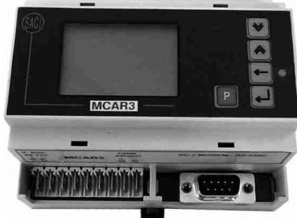
El MCAR3 es un módulo de comunicaciones para la transmisión de datos de una red de AR3DC a un ordenador de control. Dispone de dos líneas de comunicación serie, una dedicada a los medidores y otra para la conexión a al ordenador.
