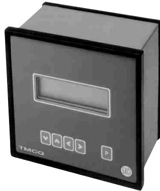
El analizador de calidad de red TMCQ detecta y registra defectos de tensión de suministro de una red, como sobretensiones o subtensiones, Dips y microcortes, que exceden los límites programados.
